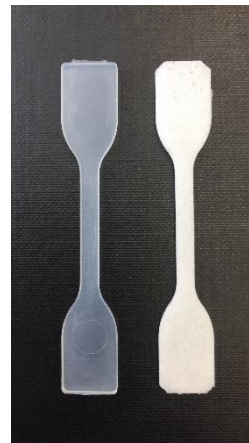
Abbildung 1: links: ungeschäumter, rechts: geschäumter Flüssigsilikonkautschuk, hergestellt im Spritzgießverfahren
