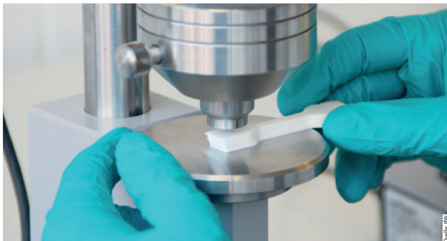
Härteprüfung von Elastomeren
