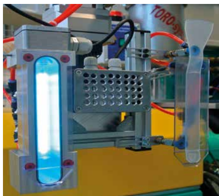
Abb. 2: UVC-Vorbehandlungseinheit am Roboter integriert (links) und hergestellter Probekörper PC-LSR in Anlehnung an die VDI-Richtlinie 2019 (rechts)
