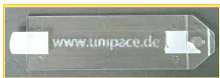
Abb. 6: Partielle Haftung von LSR auf Polycarbonat
