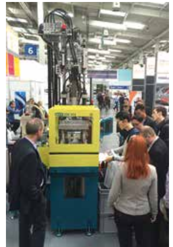
In einer vollautomatisierten Anwendung wurden Metallrohlinge für Schraubendreher mit einem festen Griffstück aus PA 6 GF und einer Weichkomponente aus LSR umspritzt.
